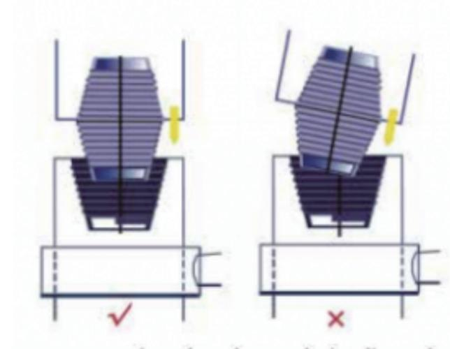
电极夹持器应夹在接头链接部位两个警戒线外侧
